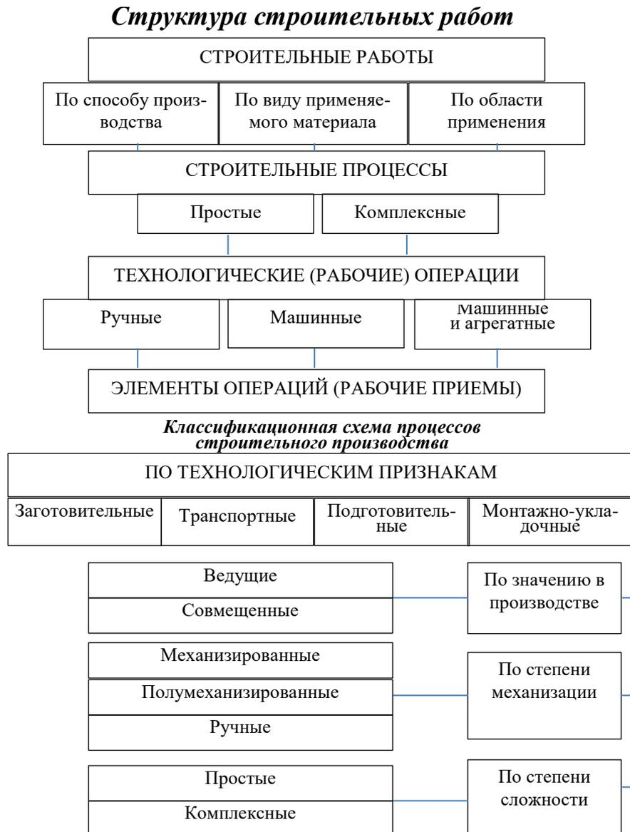
Рис. 1.1 – Классификация строительных работ и процессов
