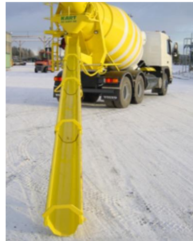
Рисунок 11 – Общий вид автобетоносмесителя с удлиненным лотком в транспортном (а) и рабочем (б) положении
