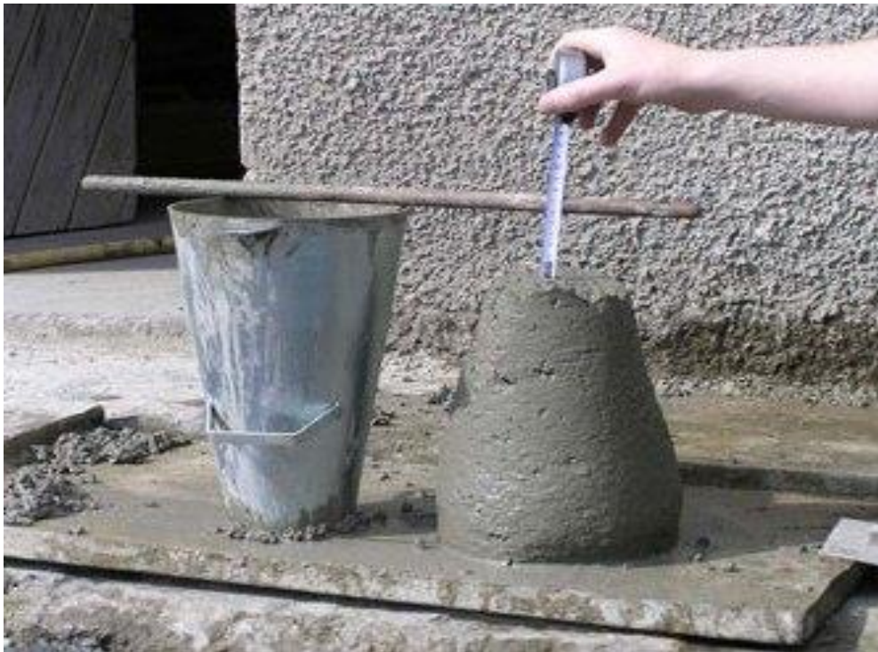
Рис. 5.1. Определение марки бетонной смеси по подвижности по величине осадки стандартного конуса
