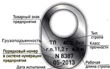
Рис. 2.22 – Маркировка стропов и марочная бирка стропа
