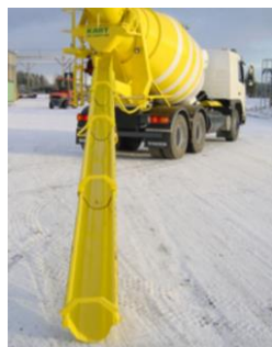
Рисунок 11 – Общий вид автобетоносмесителя с удлиненным лотком в транспортном (а) и рабочем (б) положении
