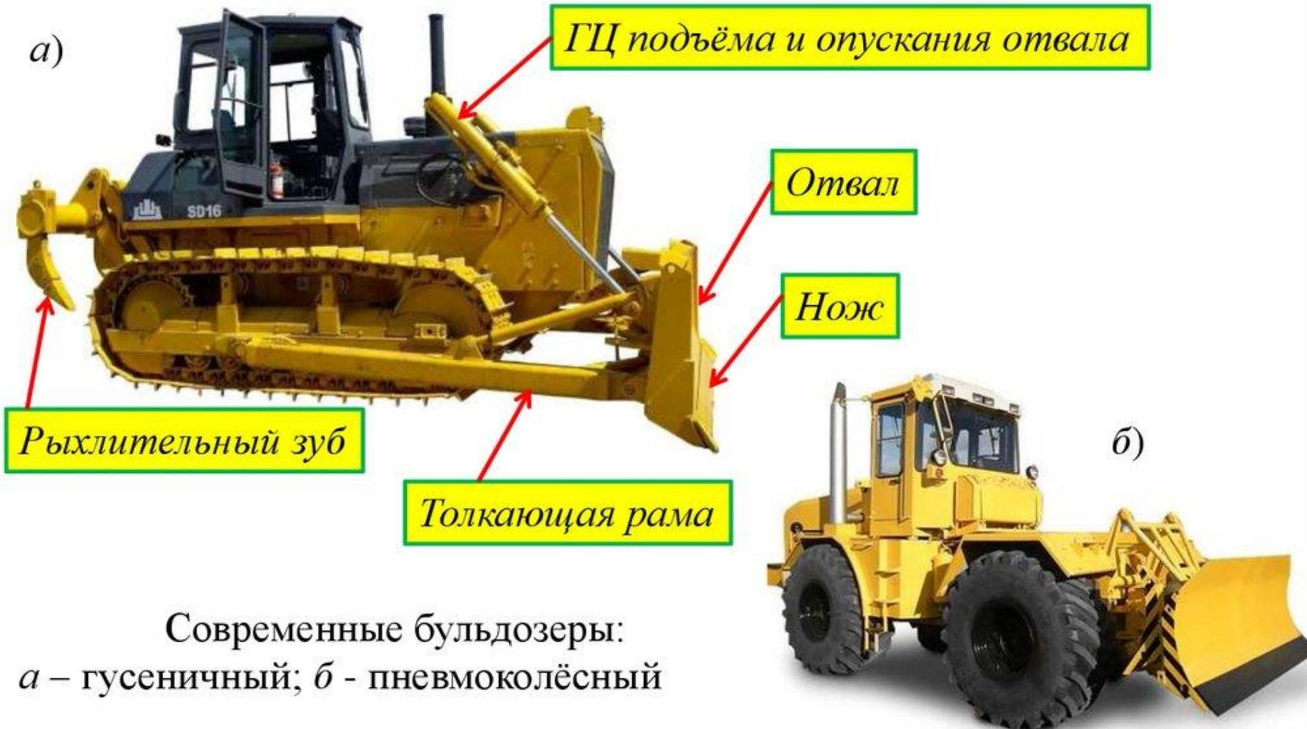
В цикл работы бульдозера входят следующие операции: резание и набор грунта методом снятия стружки; перемещение грунта на расстояние 10...70 м с надвижкой его отвалом; возвратный холостой ход.
