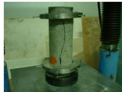
Рис. 6.3 Образец – кубик после разрушения, призматический и цилиндрический образцы в процессе нагружения
