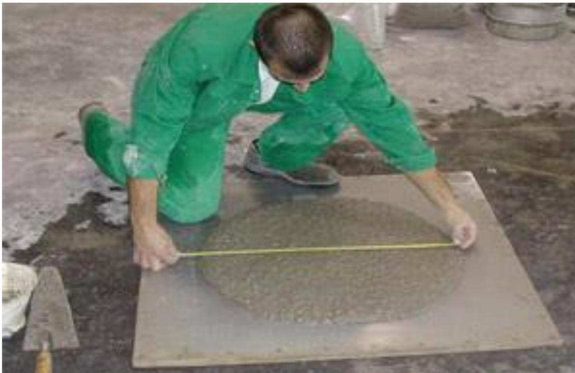
Рис. 4.3 Определение диаметра расплыва конуса из бетонной смеси
