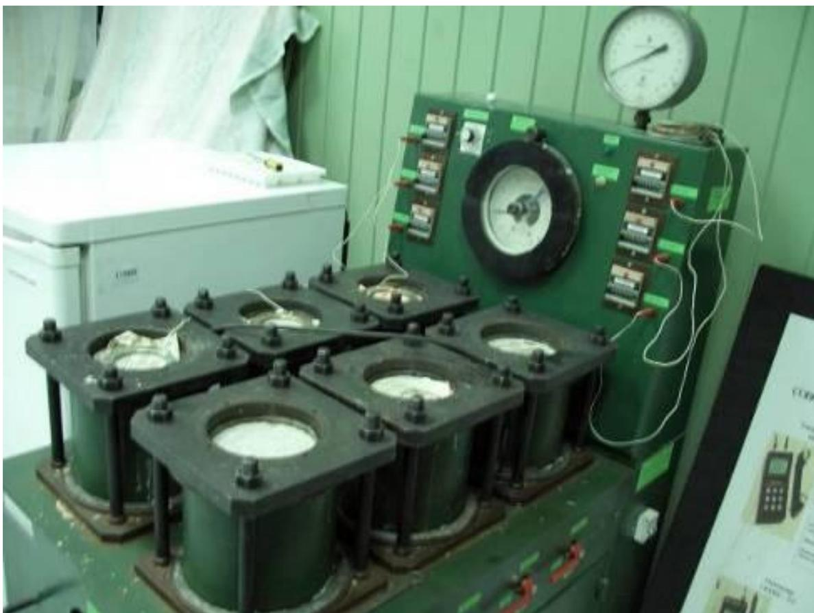
Рис. 10.5 Установка для измерения водонепроницаемости по «мокрому пятну»
