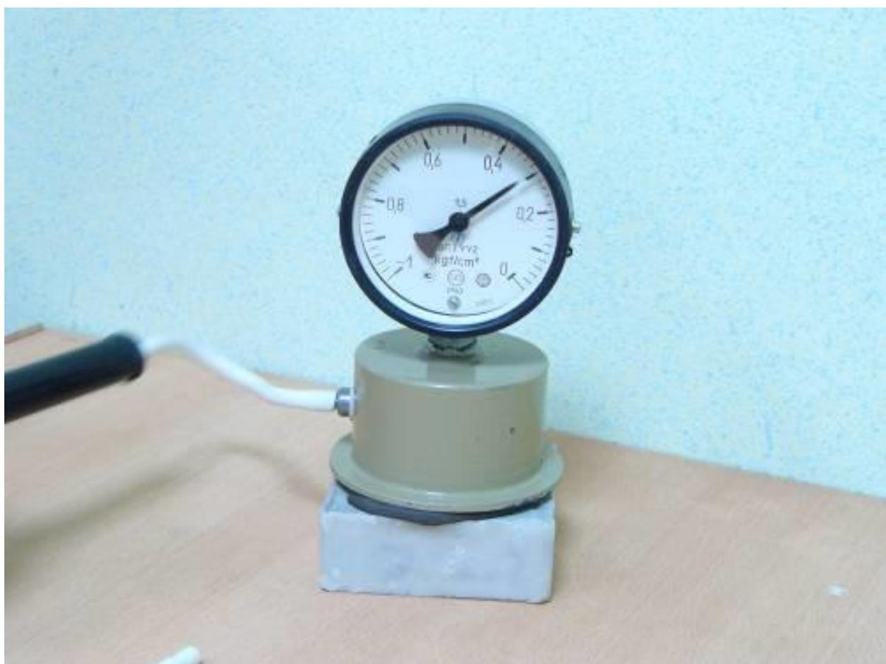
Рис. 10.7 Измерение воздухопроницаемости прибором «Агама»
