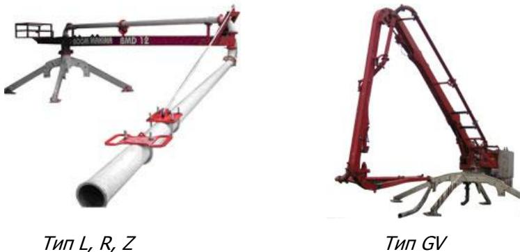
Рисунок 3.2 Конструкции бетонораспределительных стрел
