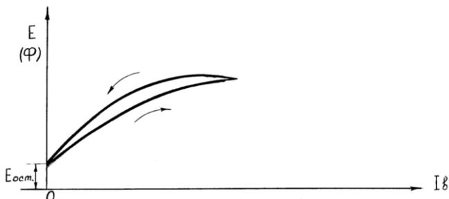
Рис. 2.16. Характеристика холостого хода трехфазного синхронного генератора.
