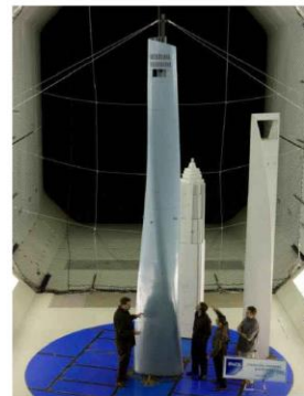
Испытание модели здания в аэротрубе
