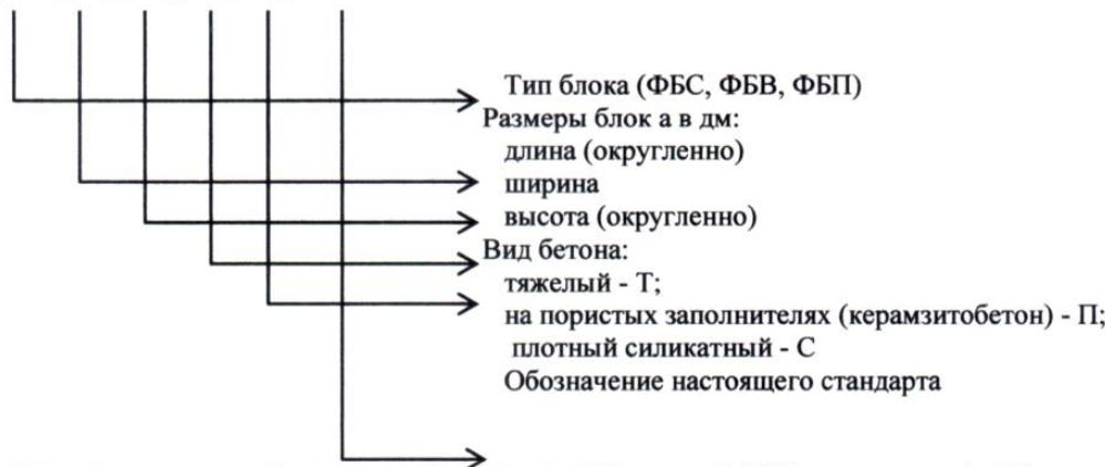
Пример условного обозначения блока типа ФБС, длиной 2380 мм, шириной 400 мм и высотой 580 мм, из тяжелого бетона: **ФБС 24.4.6 -Т ГОСТ 13579-78**.
