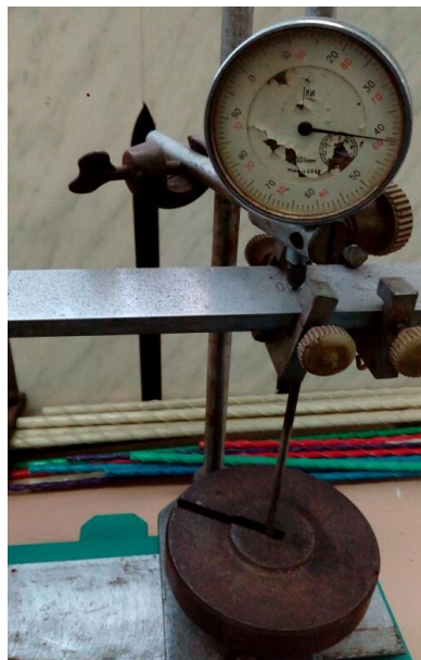
Рис. 7. Сосредоточенная нагрузка и измерение перемещения в точке
