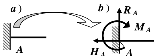
Рис. 3.18. Защемление или заделка
