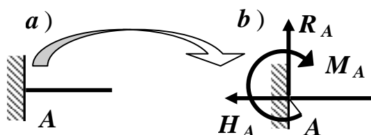
Рис. 3.18. Защемление или заделка
