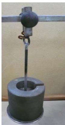
Рис. 4. Общий вид нагружения балки
