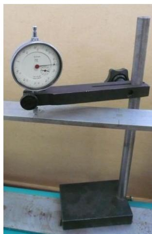
Рис. 6. Штатив с индикатором часового типа для определения прогиба балки
