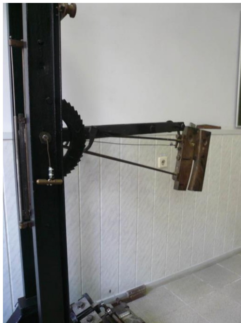
Рис. 9. Маятниковый копер МК для проведения испытаний на ударную вязкость
