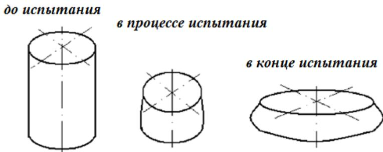
Рис.13. Деформирование стального образца
