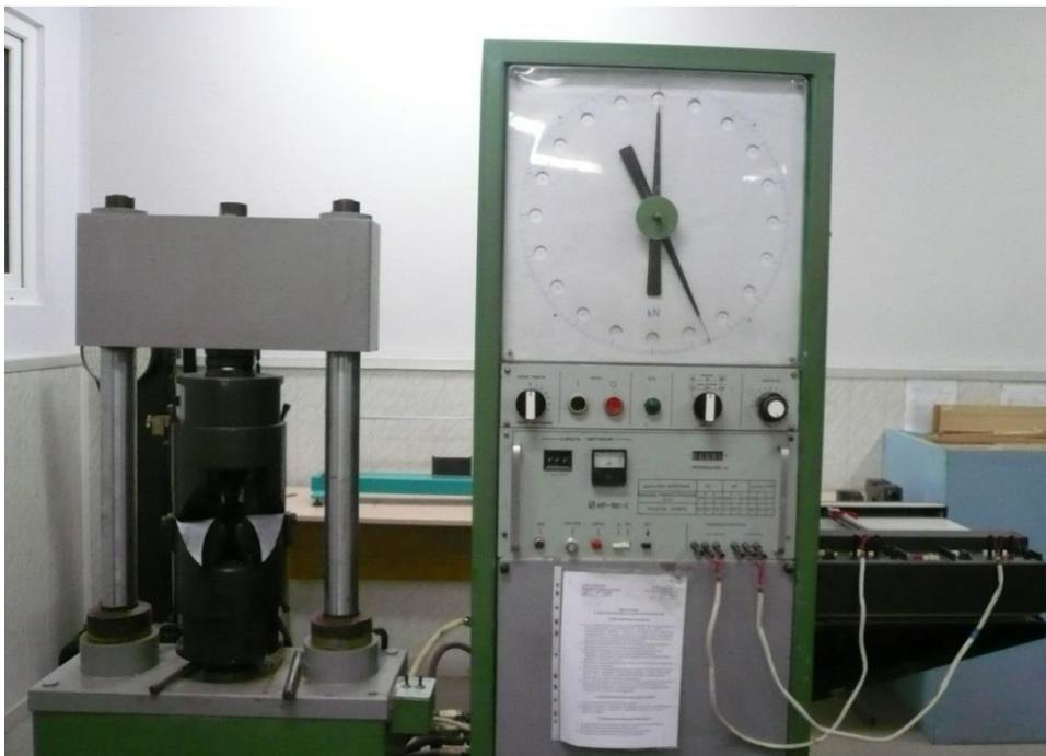
Рис.2. Общий вид испытательной машины при испытаниях на сжатие
