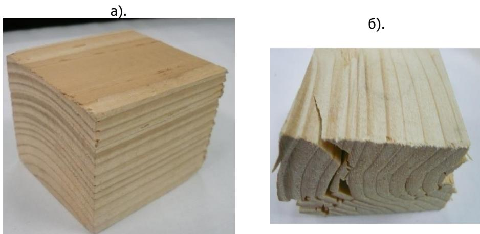
Рис.10. Образцы из дерева до (а) и после испытаний (б) на сжатие поперек волокон
