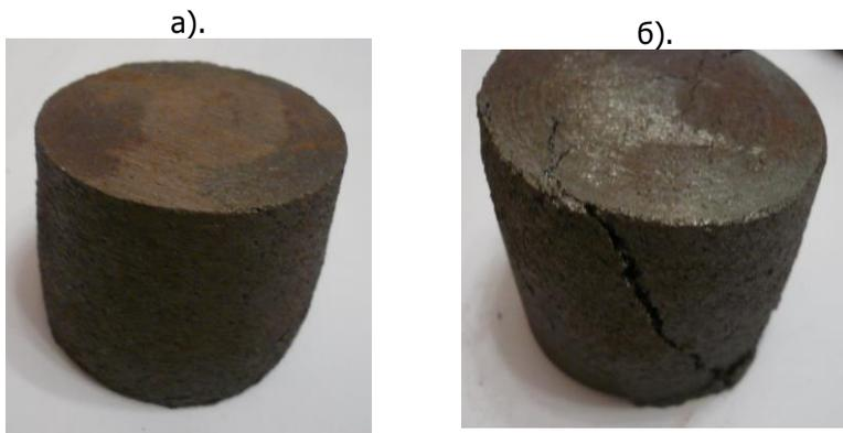
Рис.8. Образцы из чугуна до (а) и после испытаний(б) на сжатие
