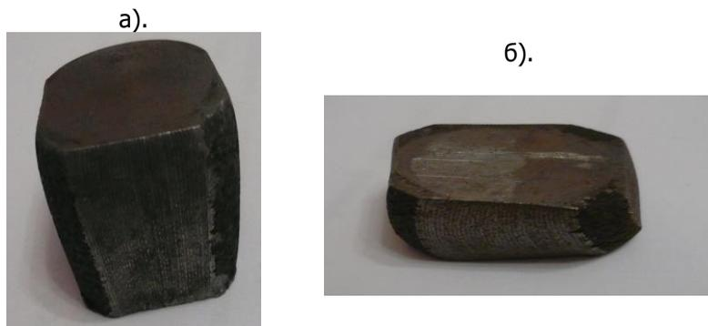
Рис.7. Образцы из стали до (а) и после испытаний(б) на сжатие
