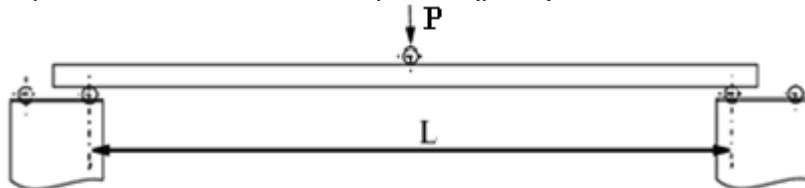
**Рис.3. Цилиндрические опоры и передача сил при изгибе**
