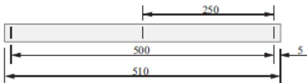
**Рис.11. Испытываемая балка с метками**
