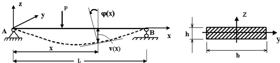
**Рис.9. Деформация балки при изгибе**
