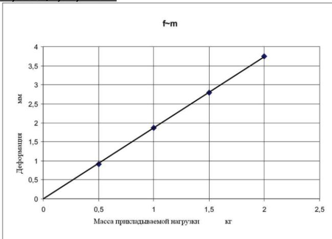
**График 1. Зависимость деформации балки от внешней нагрузки**
