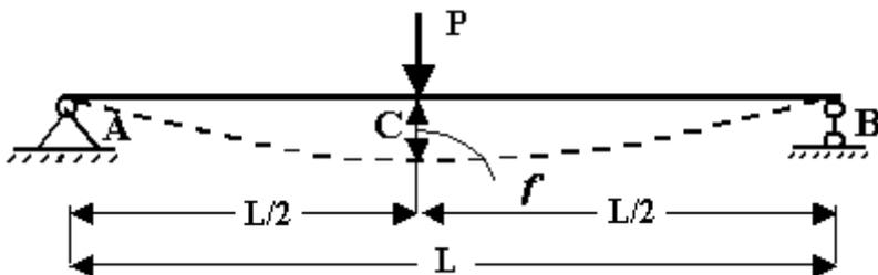
**Рис.10. Расчетная схема испытываемой балки**
