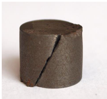
Рис. 18. Разрушение чугунного образца при сжатии.
