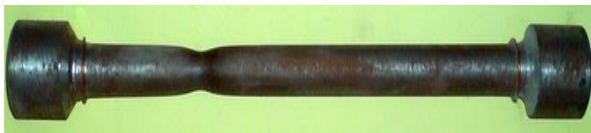
Рис. 5. Образование шейки разрыва образца
