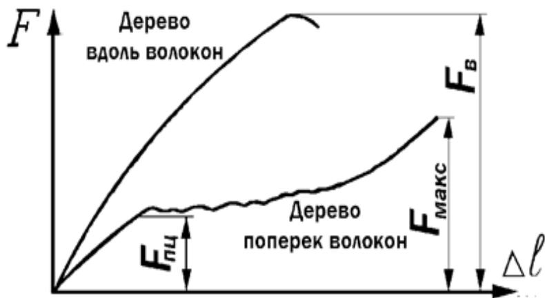
Рис. 15. Диаграмма сжатия деревянных образцов
