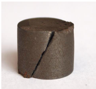
Рис. 18. Разрушение чугунного образца при сжатии.
