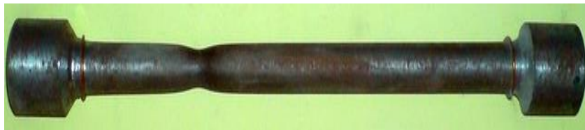
Рис. 5. Образование шейки разрыва образца
