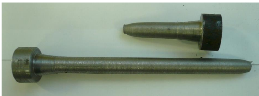
Рис.11 . Образец из стали после испытаний на растяжение
