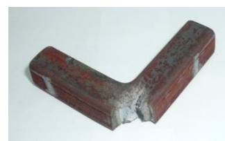
Рис.12 Образец из стали после испытаний на ударную вязкость
