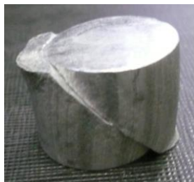
Рис.11 . Образец из стали после испытаний на растяжение
