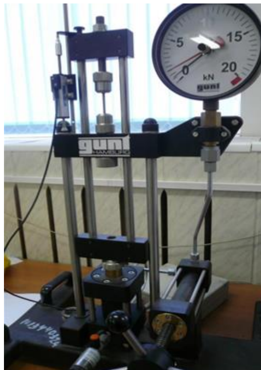
Рис. 9. Общий вид испытательной установки на растяжение.
