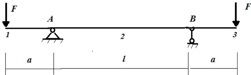
Рис. 18. Однопролетная балка с двумя консолями.
