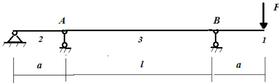
Рис. 19. Статически неопределимая балка.
