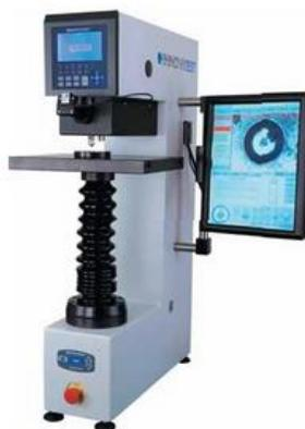
**Рис.10. Твердомеры с автоматическим проведением испытаний фирмы «INNOVATEST»**
