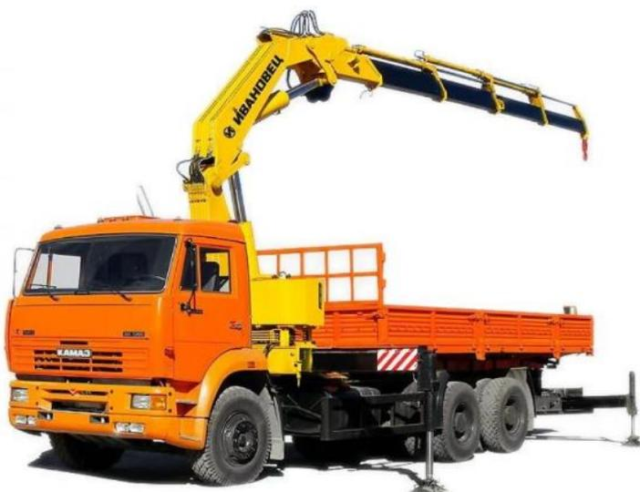
представляют собой гидравлические крановые установки с грузоподъемностью до 6 тонн. Обычно устройства устанавливаются на любое шасси отечественных или иностранных бортовых грузовых автомобилей и управляются с помощью дистанционного управления. Краны-манипуляторы выпускают как зарубежные производители – TADANO, KUKA, KATO, UNIK, SAKAI, MAEDA, CS MACHINERY, и KANGLIM, так и отечественные –
