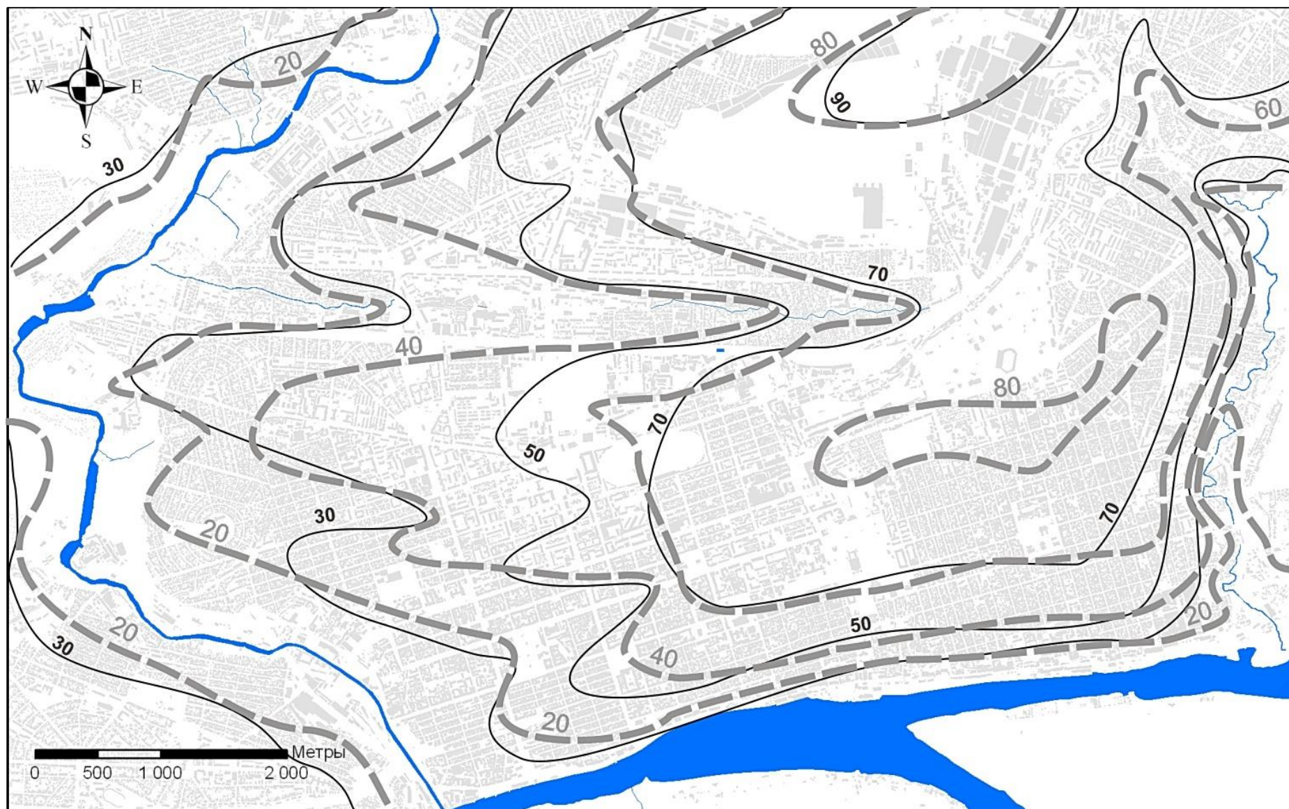
Рис. 1. Карта гидроизогипс центральной части г. Ростова-на-Дону (К.А. Меркулова 2006 г.). Сплошными линиями показаны горизонтали, штриховыми – гидроизогипсы
