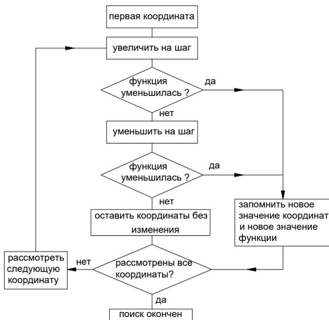
Рис. 5.6. Блок-схема исследующего поиска
