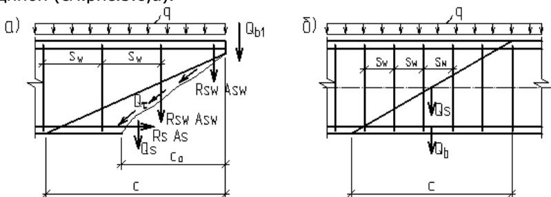
Рис.3.8. К расчету по наклонному сечению
