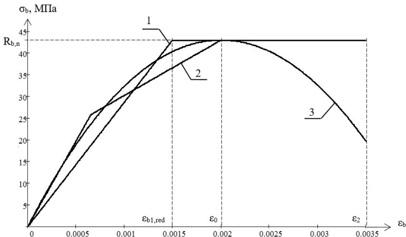
Рис.4.5. Диаграммы состояния бетона класса В60 при одноосном сжатии:
