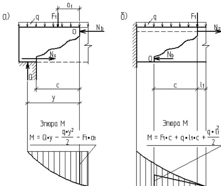
Рис.3.11. Определение значения изгибающего момента:
