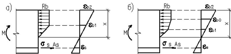
Рис.4.1. Схема напряжений и деформаций в поперечном сечении:
