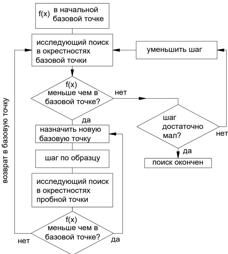
Рис. 5.7. Блок-схема поиска по образцу
