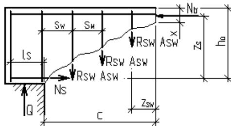
Рис.3.10. Схема усилий в наклонном сечении при расчете его по изгибающему моменту
