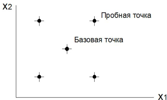
Рис. 5.3 Образец в случае двух управляемых переменных
