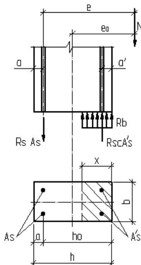
Рис.3.5. Схема внешних сил и внутренних усилий в нормальном сечении внецентренно сжатого элемента
