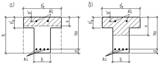
Рис.3.3. К определению положения границы сжатой зоны бетона:
