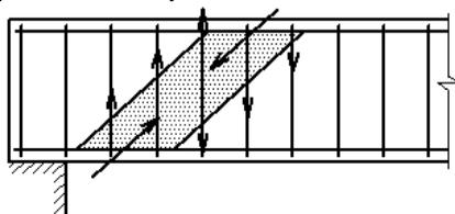
Рис.3.7. Схема усилий на бетонную полосу между наклонными сечениями
