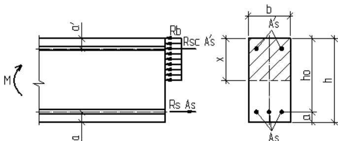
Рис.3.1. Схема внешних сил и внутренних усилий в нормальном сечении изгибаемого элемента
