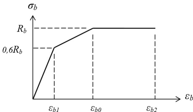
Рис.4.3. Трехлинейная диаграмма "σ<sub>b</sub>–ε<sub>b</sub>"
