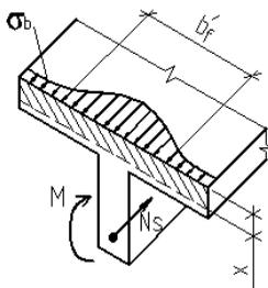
Рис.3.2. Распределение сжимающих напряжений по ширине полки
