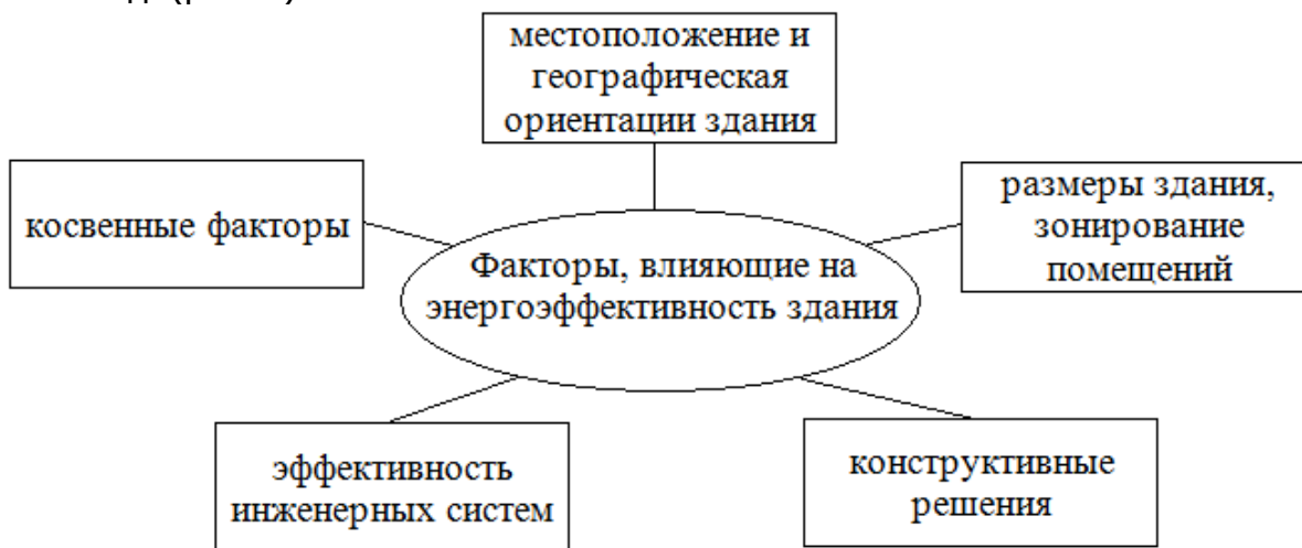
Рис. 1. Факторы, влияющие на энергоэффективность здания
