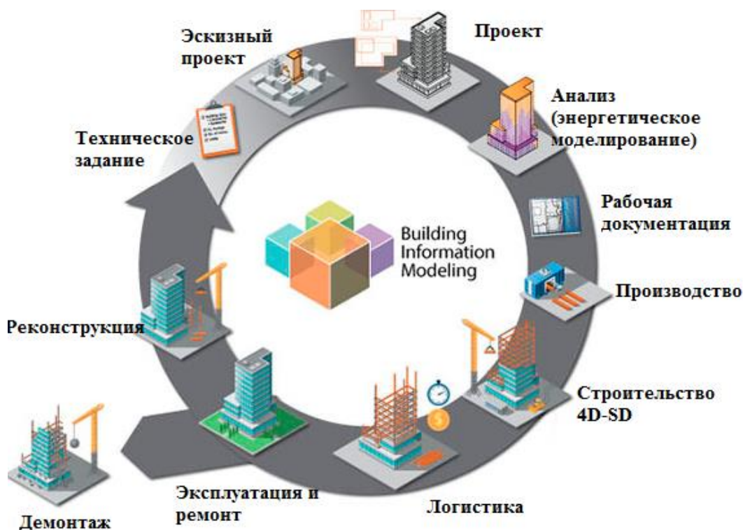
Рисунок 7 – Схема информационной модели здания
