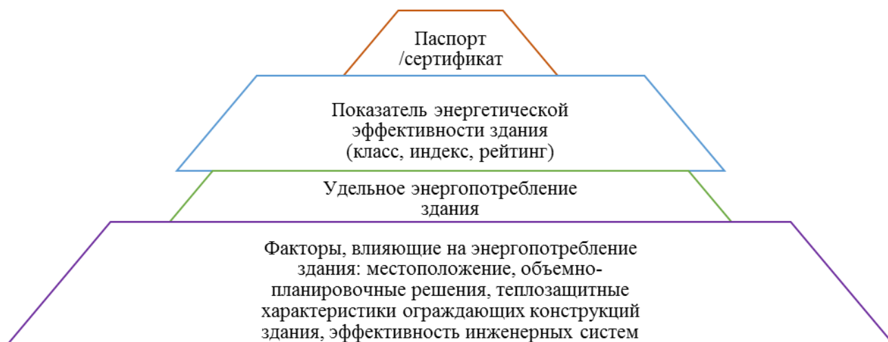
Рисунок 3 – Общая схема разработки энергетического паспорта/сертификата здания
