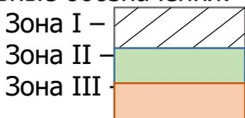
В рассматриваемом примере, исходя из размеров пола по грунту, получилось выделить только три зоны. Формирование четвертой зоны невозможно, т.к. ширина внутренней 3-ей зоны составляет 3,3 м (менее 4 м, т.е. отступить по два метра не получится).
