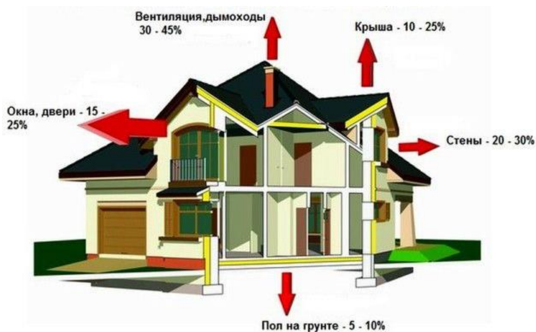
Рисунок 7 – Потери тепловой энергии через ограждающие конструкции здания
