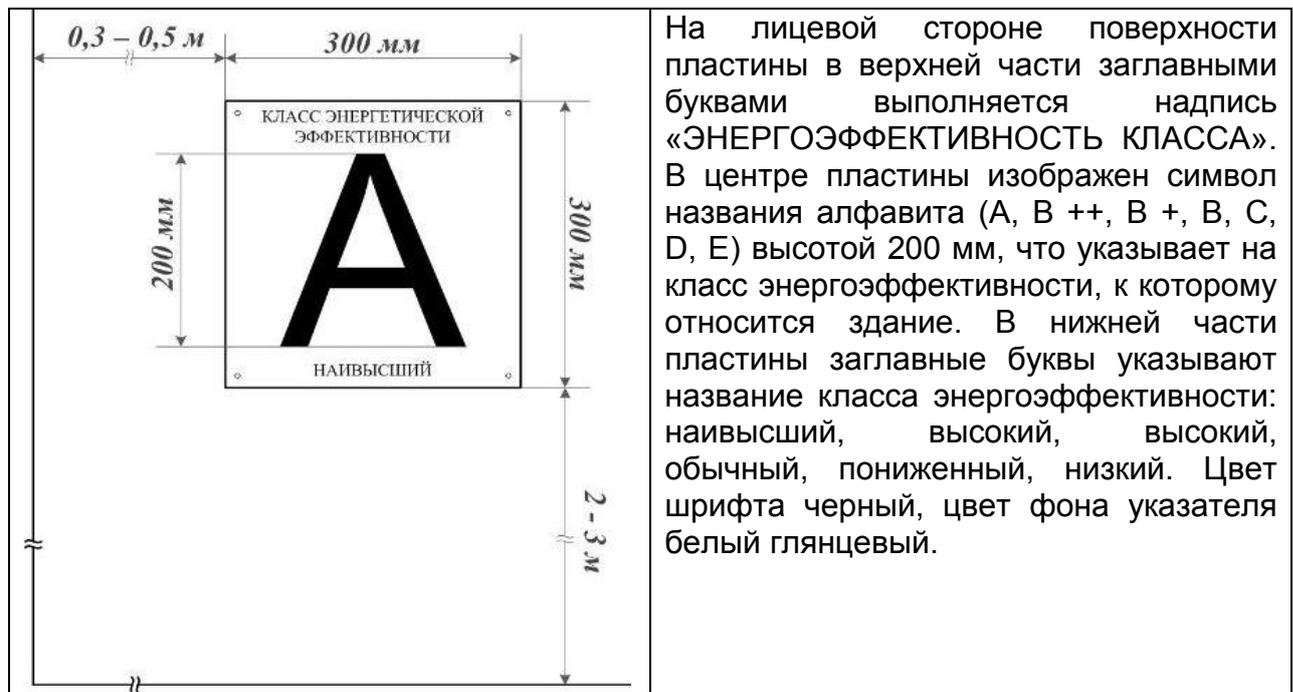
Рисунок 6 – Схематическое представление эффективности энергопотребления класса указателя
