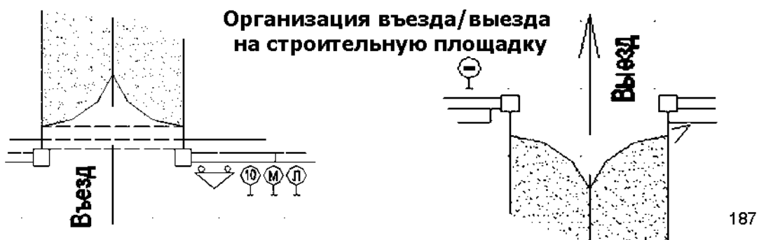
Рис.18 – Организация въезда на строительную площадку
