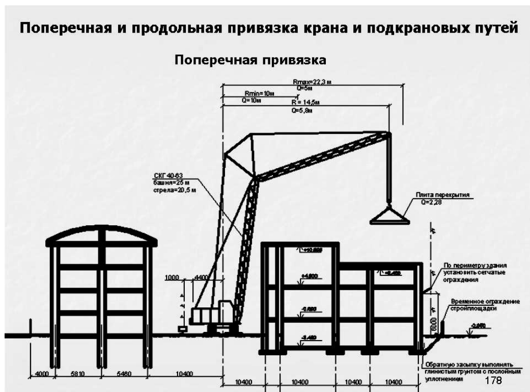
Рис. 16 – Поперечная и продольная привязка крана и подкрановых путей
