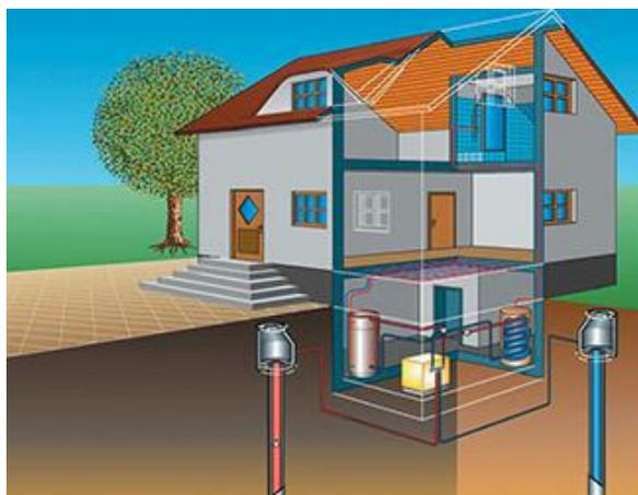
Рис.10. Схема работы теплового насоса с горизонтальным и вертикальным грунтовым теплообменником
