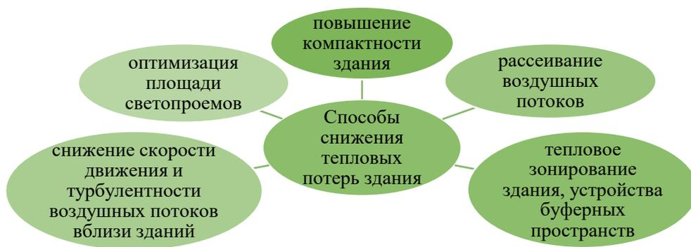
Рис.7. Объемно-планировочные и ландшафтные мероприятия по снижению тепловых потерь здания
