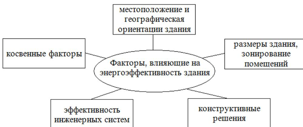
Рис. 2. Факторы, влияющие на энергоэффективность здания
