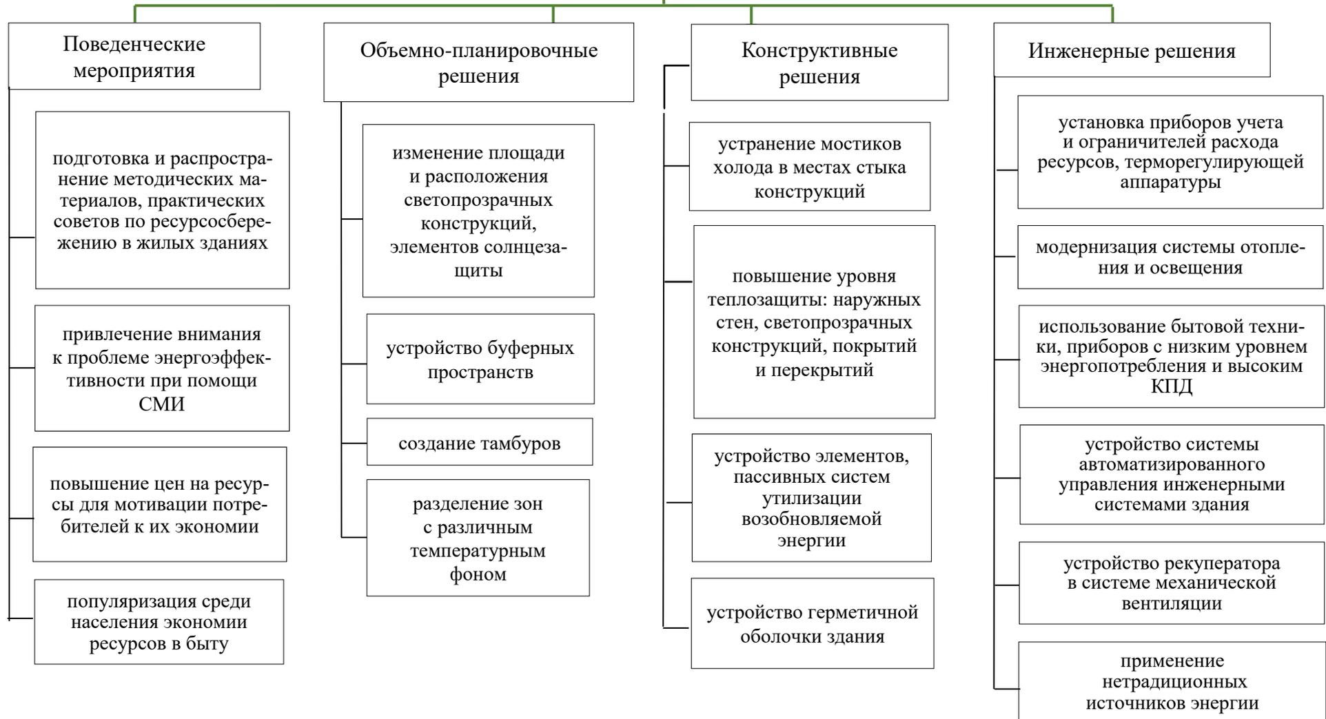
Рис. 3.7. Примеры энергосберегающих решений, реализуемых на этапе эксплуатации здания
