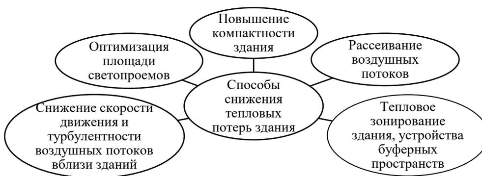
Рис. 3.9. Объемно-планировочные и ландшафтные мероприятия по снижению тепловых потерь здания
