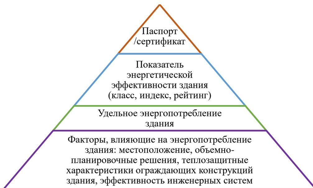
Рис. 3.4. Общая схема разработки энергетического паспорта/сертификата здания
