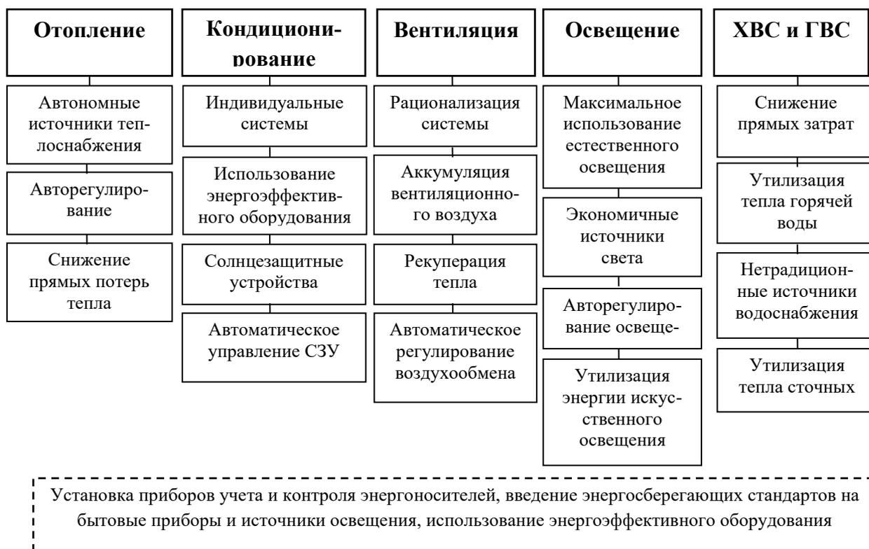
Рис. 3.17. Мероприятия по повышению энергоэффективности инженерных систем в жилых зданиях
