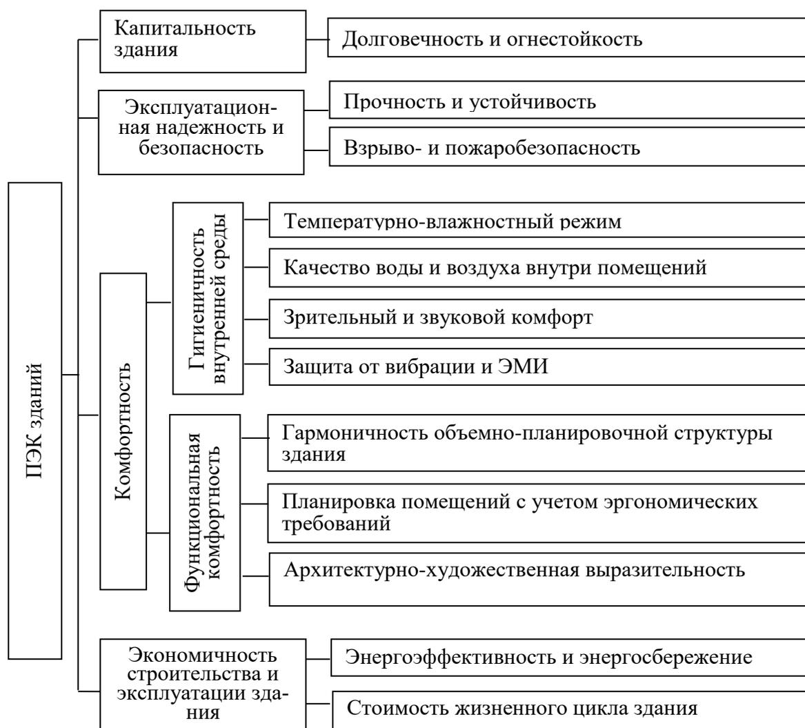
Рис. 2.5. Классификация параметров эксплуатационных качеств современных жилых зданий
