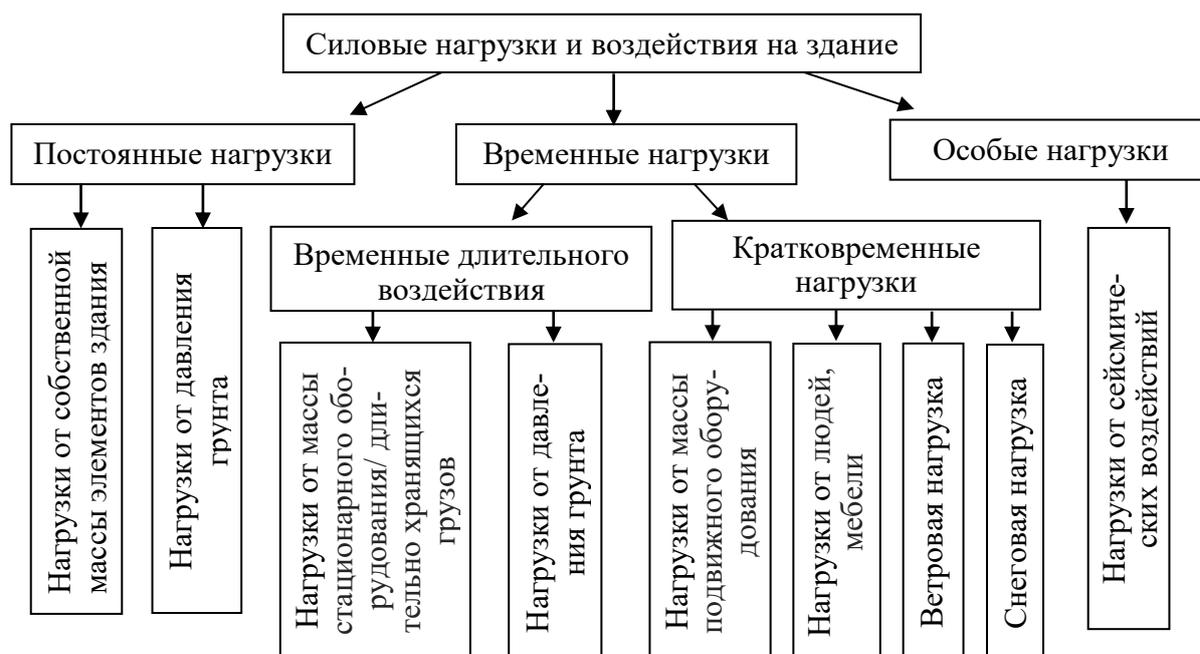
Рис. 2.6. Классификация силовых нагрузок на здание
