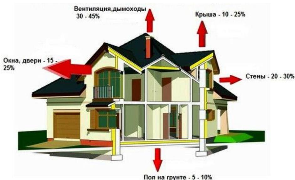
Рис. 3.8. Потери тепловой энергии через ограждающие конструкции здания
