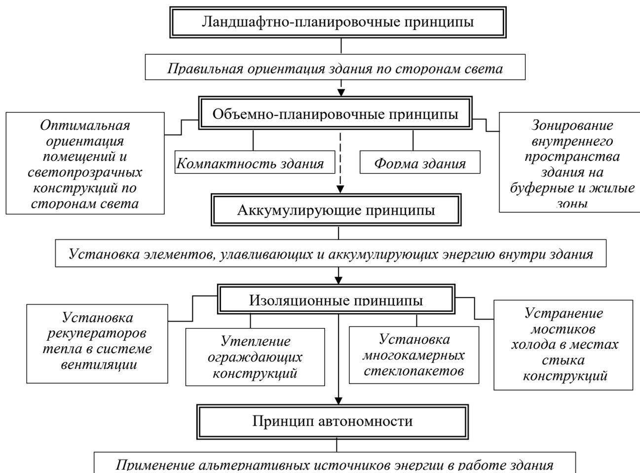
Рис. 3.28. Принципы проектирования и строительства пассивных зданий
