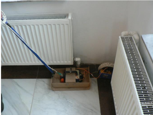
Рис. 48 и 49 – Георадиолокационная съемка профилей в направлении «Юг – Север» с использованием антенного блока АБ – 1700
