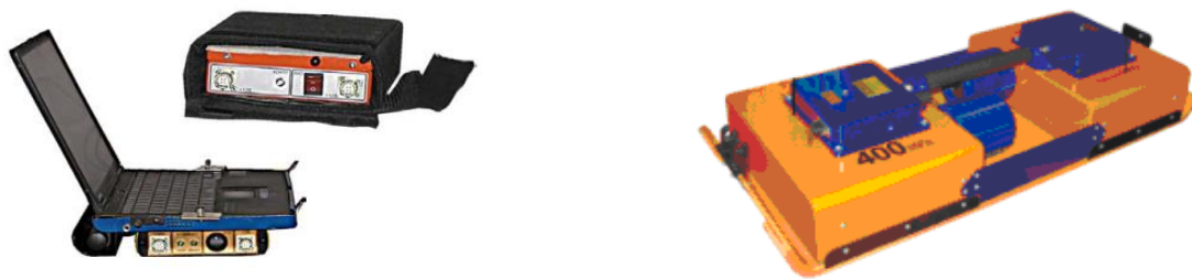
Рис. 32 и 33 – Георадиолокатор (георадар) «ОКО – 2» и антенный блок АБ – 400
