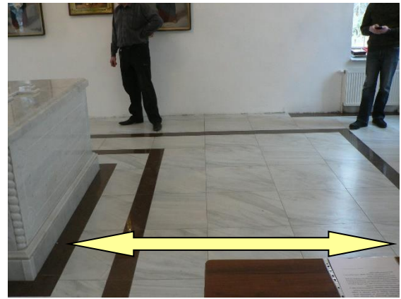
Рис. 44 – 45 – Выбор расположения профилей георадиолокационного зондирования помещения объекта в направлении «Юг – Север»
