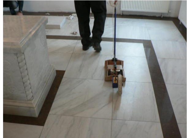
Рис. 48 и 49 – Георадиолокационная съемка профилей в направлении «Юг – Север» с использованием антенного блока АБ – 1700
