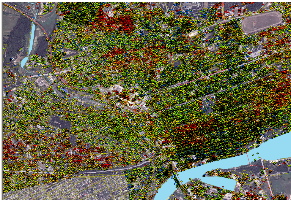
Рис. 25 – Очаги вертикальных смещений территории г.Ростова-на-Дону, полученные на основе данных интерферометрической съемки. Красные точки указывают на значительные оседания земной поверхности
