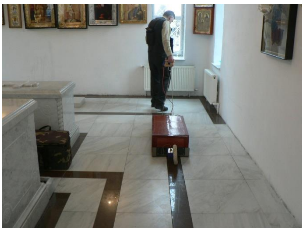
Рис. 52 и 53 – Георадиолокационная съемка профилей в направлении «Юг – Север» с использованием антенного блока АБ – 400
