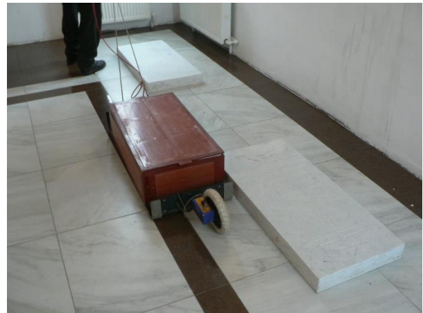
Рис. 50 и 51 – Георадиолокационная съемка профилей в направлении «Восток – Запад» с использованием антенного блока АБ – 400
