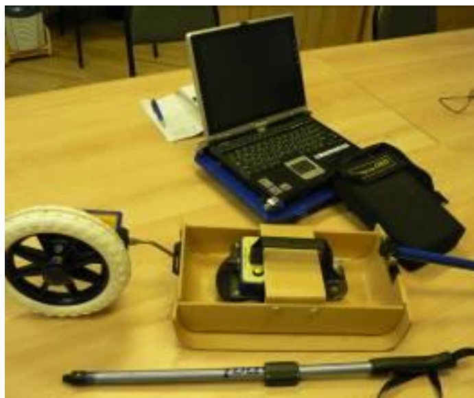
Рис. 41 – Георадиолокатор (георадар) «ОКО – 2» с антенным блоком АБ – 1700
