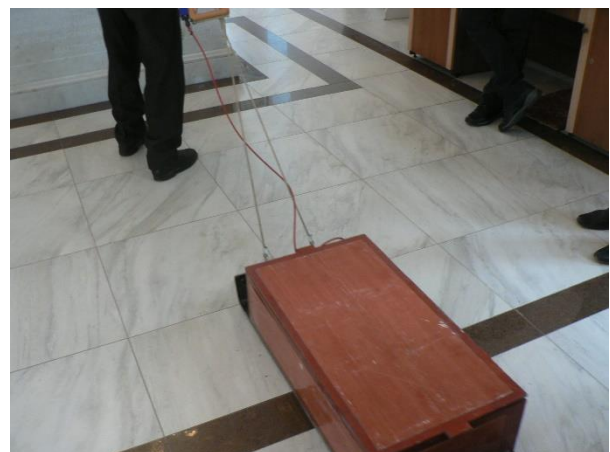
Рис. 52 и 53 – Георадиолокационная съемка профилей в направлении «Юг – Север» с использованием антенного блока АБ – 400
