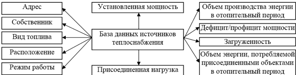
Рисунок 52 – Элементы базы данных источников теплоснабжения
