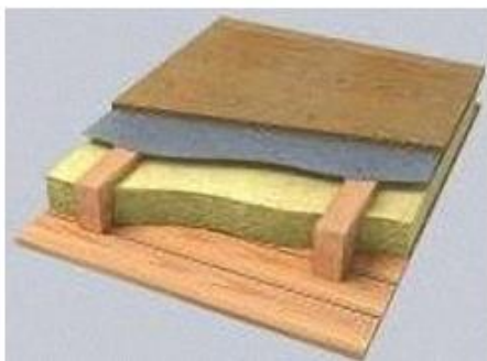
Рисунок 24– Утепление деревянного перекрытия
