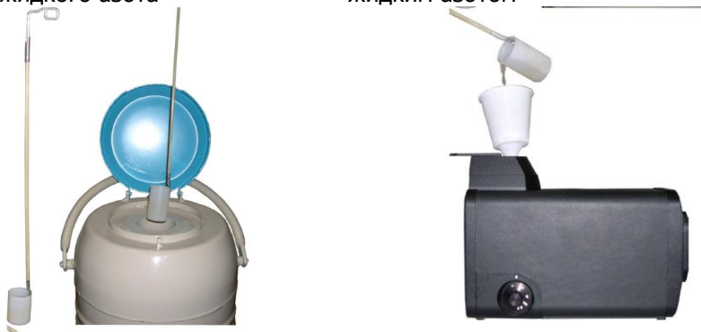
Рисунок 34– Внешний вид тепловизора ИРТИС-2000
