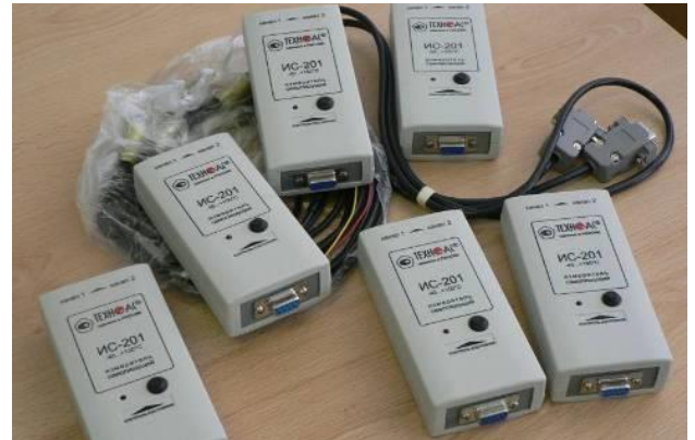
Рисунок 2.21. Измерители-регистраторы самопишущие ИС -201
