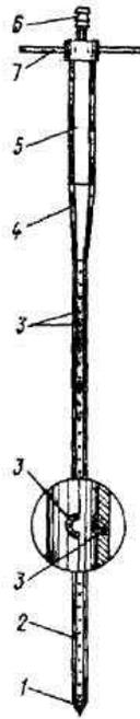
Рисунок 8. Инъектор с уплотняющим контуром
