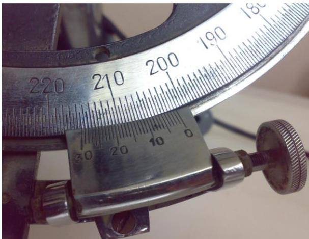
Рисунок 4 - Лимб гониометра со шкалой нониуса
