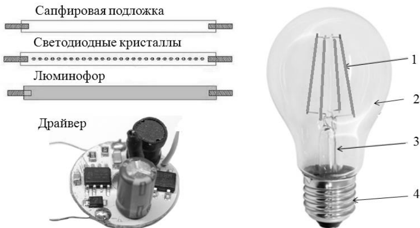
Рис. 15. Устройство филаментной лампы
