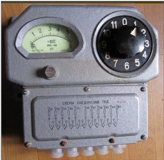
Рис. 3.11. Термоэлектрический дизельный комплект ТКД-50М.
