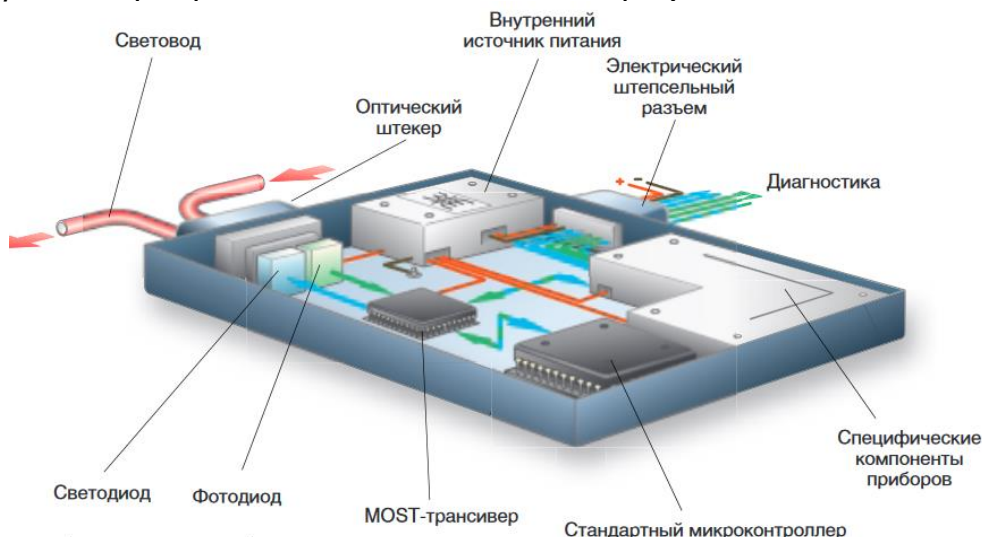
Рис. 5.8. Схема расположения блоков управления шиной MOST
