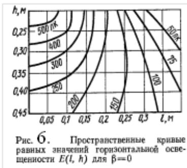
Рис. 6. Пространственные кривые равных значений горизонтальной освещенности  $E(l, h)$  для  $\beta=0$
