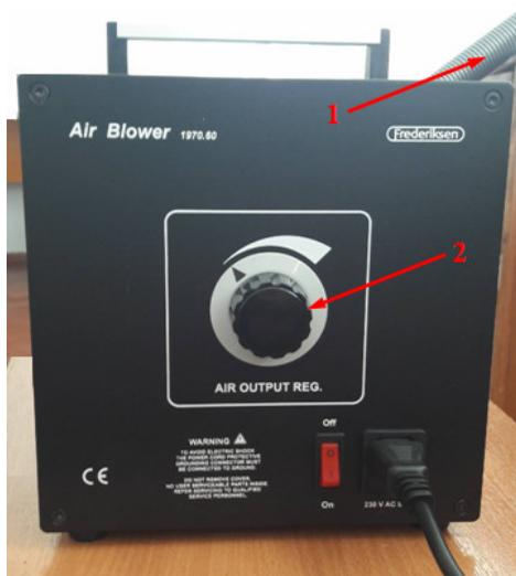
Рис. 4. Воздуходувка для нагнетания воздуха в трек
