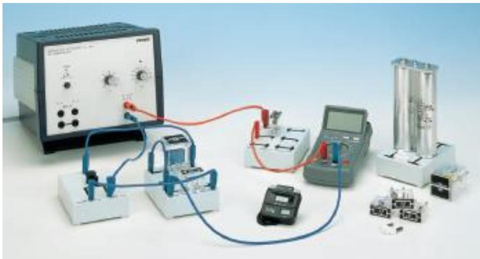
Рис. 7. Экспериментальная установка для измерения тока зарядки конденсатора.
