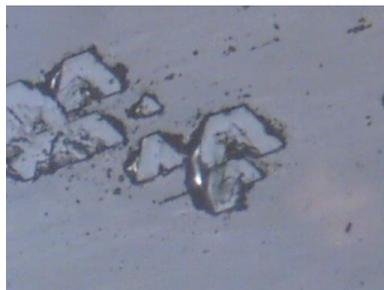
**Рис. 6.15.** Пирамидки роста ЭС  $\text{GaInAs}_{<\text{Bi}>}/\text{InAs}$  при  $G > 75 \text{ K/cm}$
