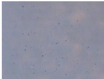
**Рис. 6.16. Поверхность поликристаллической пленки GaInAs<Bi>/InAs. Увеличение  $\times 350$**
