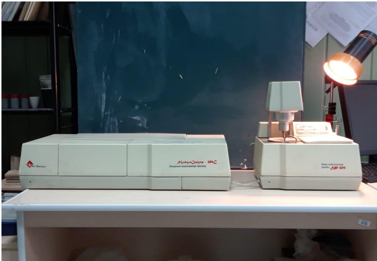
Рисунок 2 – Прибор для определения зернового состава тонкодисперсных материалов
