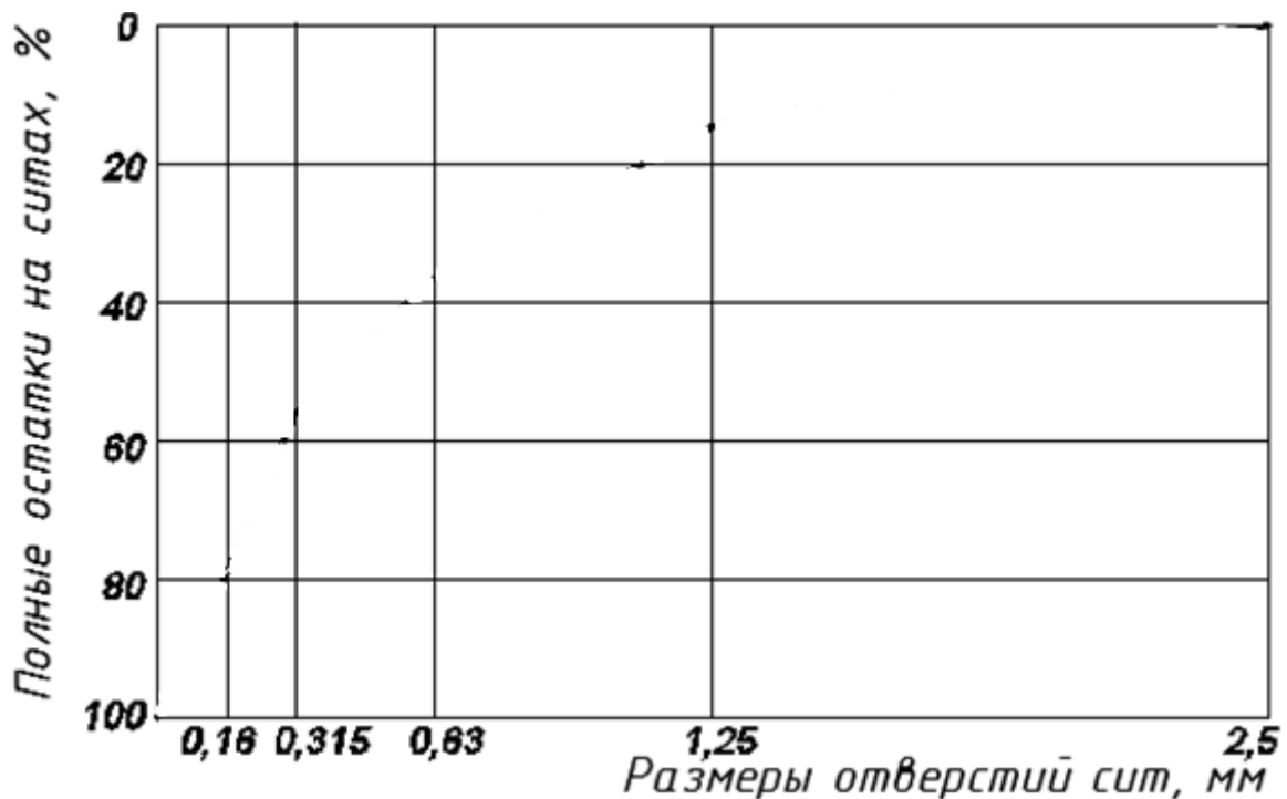
Рисунок 1 – Кривая просеивания мелких заполнителей
