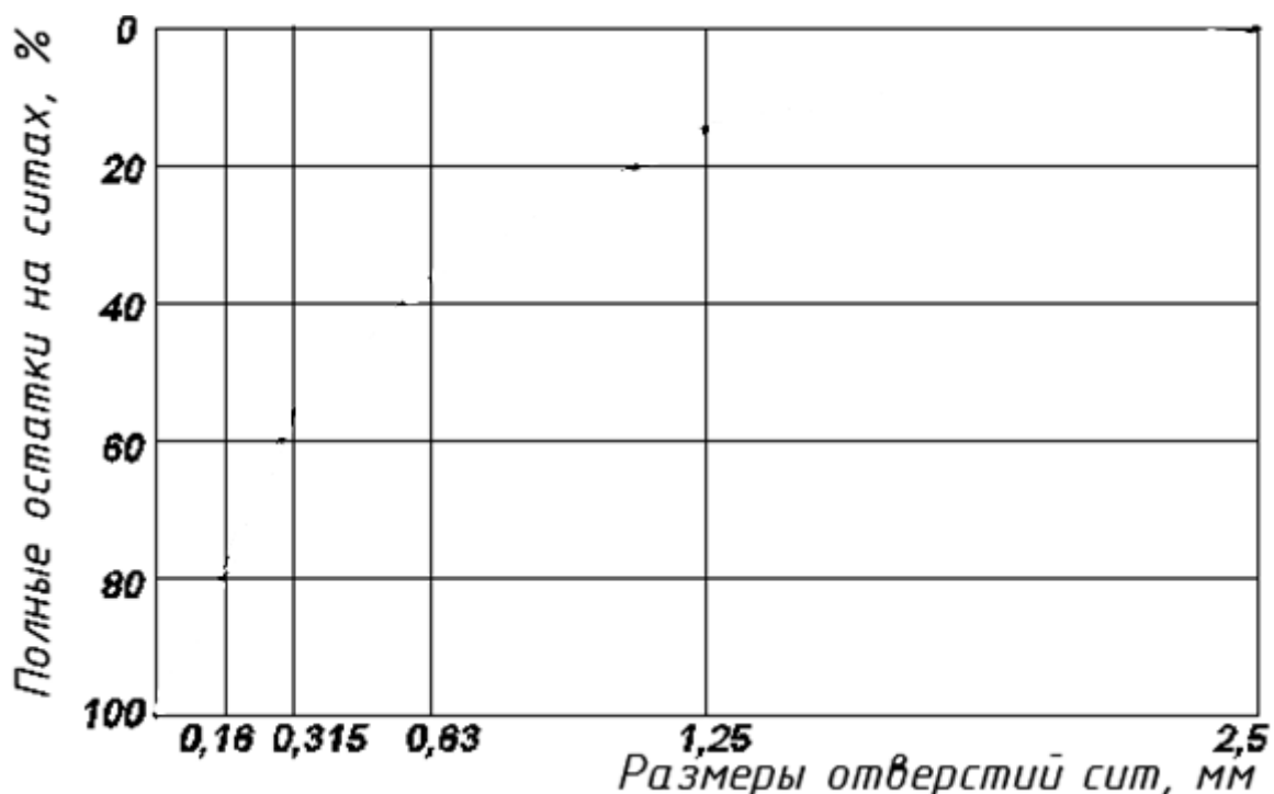
Рисунок 1 – Кривая просеивания мелких заполнителей
