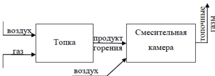
Рис. 1.5 Общая схема получения топочных газов
