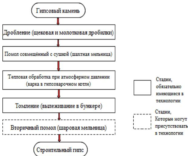
Рисунок 1 – Технологическая схема производства гипса с применением варочных котлов
