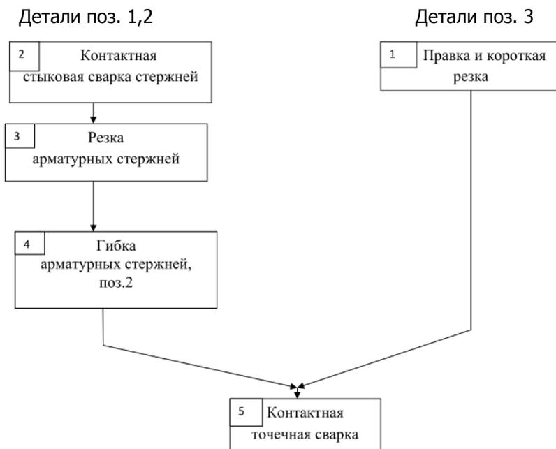
Рисунок 5 – Маршрутная операционная технологическая схема изготовления плоских каркасов КП-3
