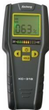
Рис. 6. Бесконтактный экспресс-измеритель влажности материалов KC318
