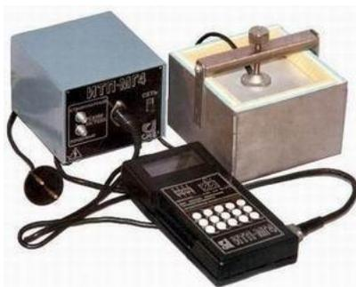
Рис. 1 . Измеритель теплопроводности ИТП-МГ4
