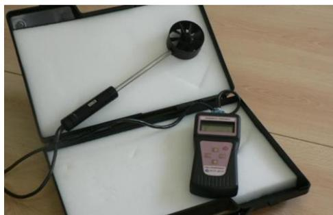
Рис. 2. Цифровой анемометр-термометр ИСП-МГ 4.01 для измерения средней скорости направленного воздушного потока и его температуры
