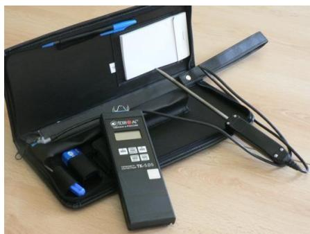
Рис. 5. Термометр контактный цифровой ТК-5.05 для измерения температуры поверхностей твердых тел
