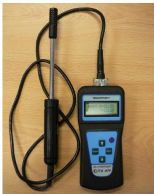
Рис. 4. Измеритель температуры и относительной влажности воздуха (термогигрометр) ТГЦ-МГ 4.01 для контроля и регистрации температуры и влажности воздуха при оценке температурно-влажностного режима помещений
