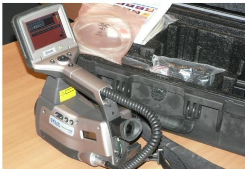
Рис. 6. Тепловизор ThermaCAM™ P65 (24°x18°/ 0.3 м (0.98 фт), 7.5-13 μm) для бесконтактных измерений при комплексном тепловом контроле строительных конструкций (метод теплового неразрушающего контроля – ТНК).
