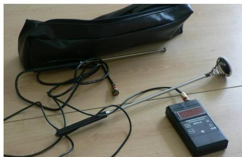
Рис. 3. Измеритель плотности теплового потока ИПП-2 для измерения плотности тепловых потоков по ГОСТ 25380-92, проходящих через однослойные и многослойные ограждающие конструкции зданий и сооружений
